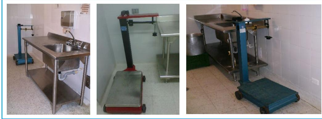
*Báscula mecánica de 500 kg. con plataforma de 0.51 m de frente, 0.66 m de fondo y 1.00 m de alto.*
