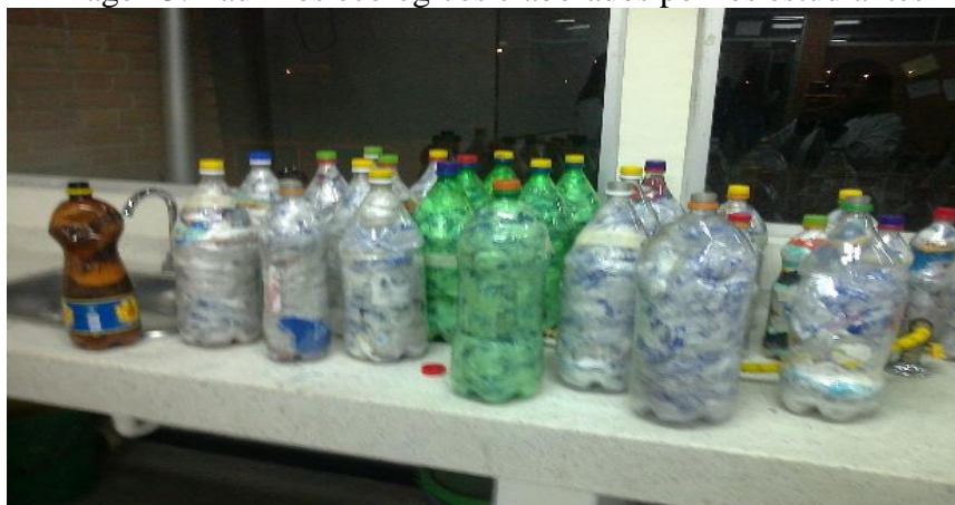
Imagen 3. Ladrillos ecológicos elaborados por los estudiantes
