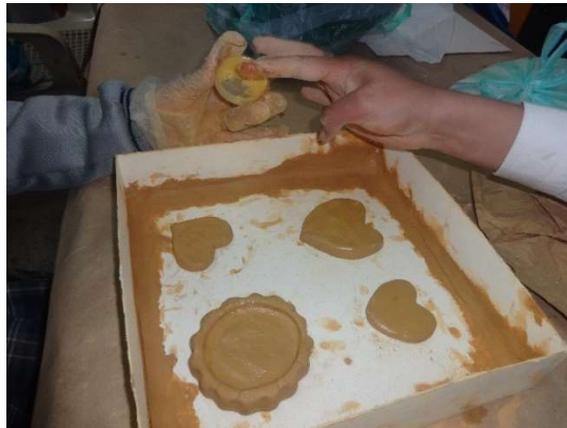
Ilustración-56 Estudiantes ubicando modelos en arcilla en el bastidor, están aplicando vaselina con el fin de facilitar desmolde del yeso roca.
