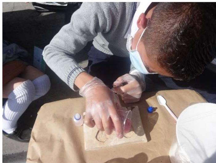
*Ilustración-63 Estudiante vertiendo mezcla de resina poliéster en el molde.*
