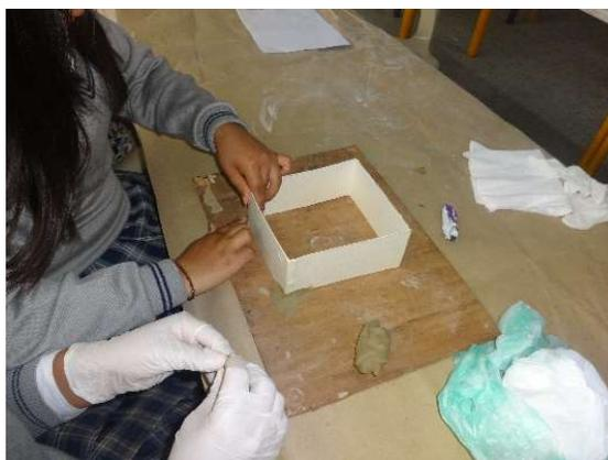
Ilustración; **Error! Utilice la pestaña Inicio para aplicar 0 al texto que desea que aparezca aquí.**-54 Estudiante en proceso de elaboración de bastidor. El bastidor es una caja para verter el yeso roca. Se puede realizar en madera o como en este caso en cartón paja.
