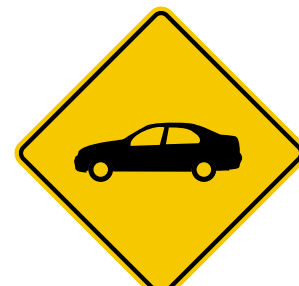
I. SPC-01 Vehículos en la vía cicla Advierte sobre la proximidad de vehículos automotores.
